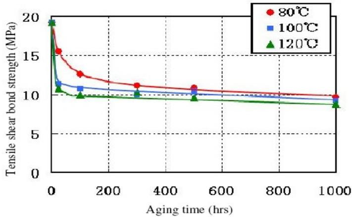
**Fig. 1 Resistencia térmica de TB1757
