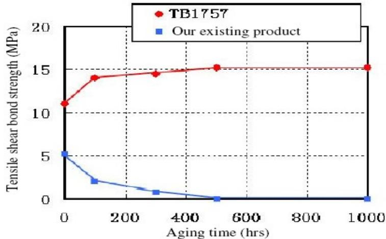
**Fig 3. Resistencia térmica de TB1757**
