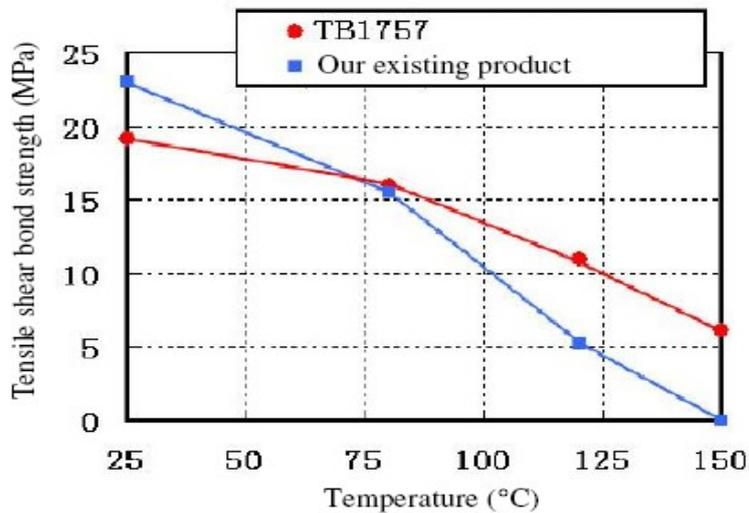
**Fig 2 Resistencia térmica de TB1757
