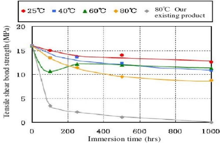
Fig. 5 Resistencia al agua de TB1757
