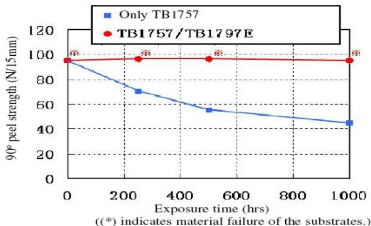
Fig. 8 Resistencia a la humedad entre diferentes materiales.
