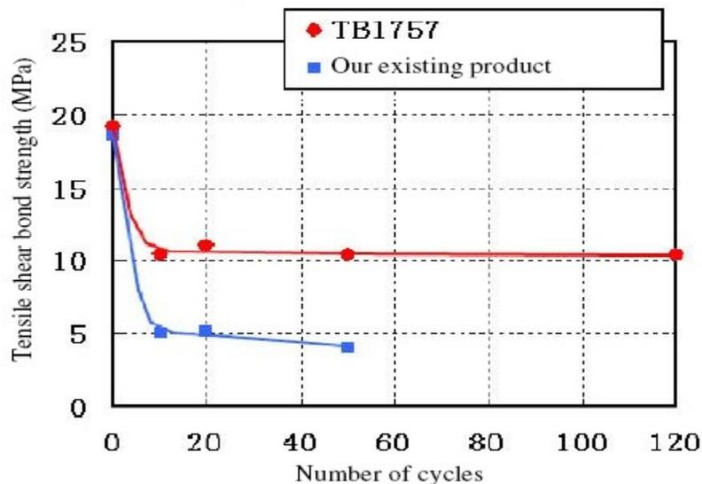
**Fig 4. Resistencia al ciclo de calor de TB1757**
