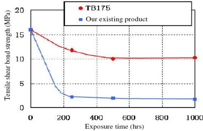
Fig. 7 Resistencia a la humedad de TB1757 con muestras de aluminio.
