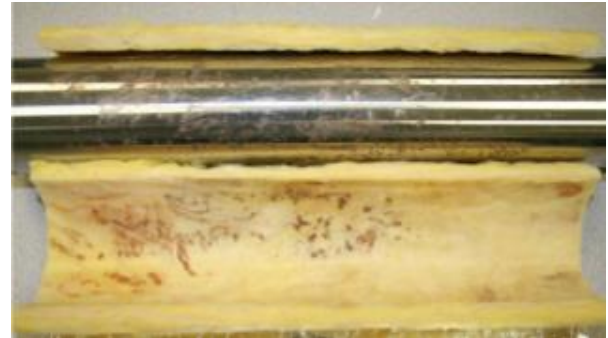
Tubo desprotegido, después de 240 horas de prueba en condiciones de alta temperatura con una inyección normal de cloruro.
