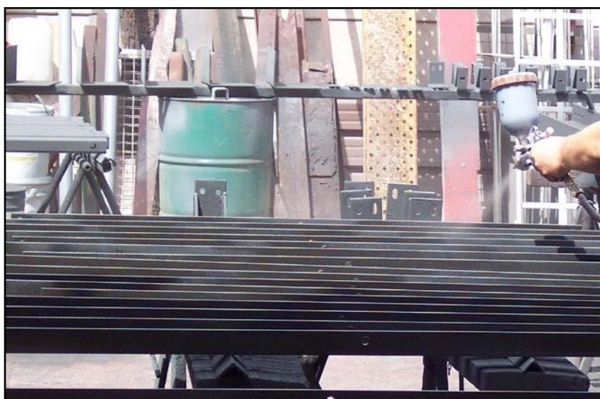
Aplicación de recubrimiento poliuretano alifático con inhibidores Q-365E:
