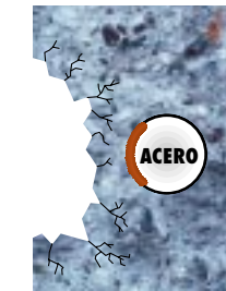
Remueva el hormigón desprendido de la estructura deteriorada.
